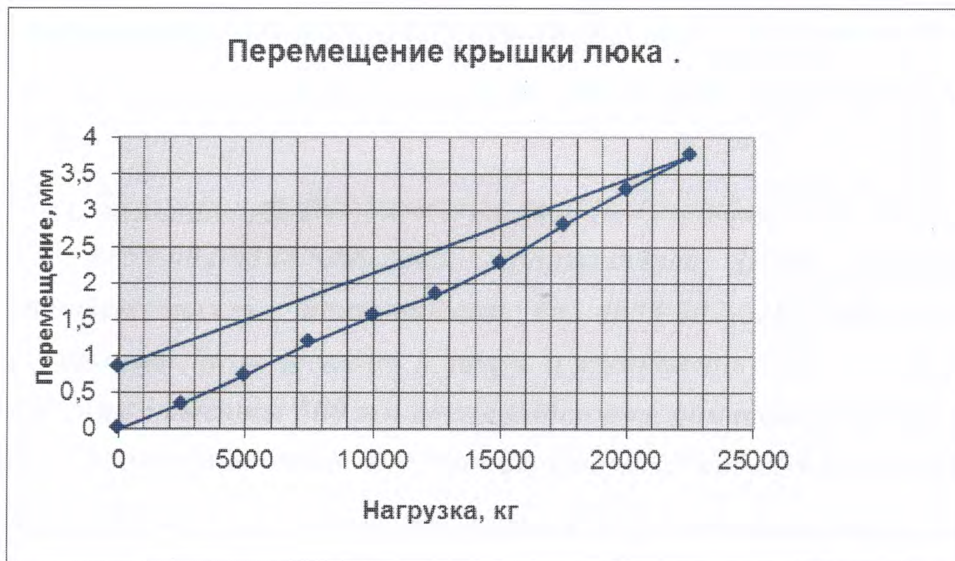
Рисунок 2 – График перемещения крышки люка при сосредоточенной нагрузке
