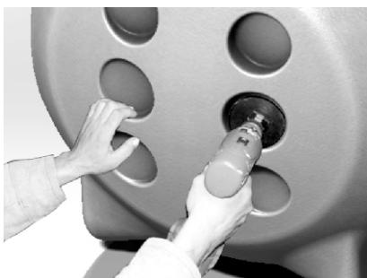
РИСУНОК 1. СВЕРЛЕНИЕ ОТВЕРСТИЯ ДЛЯ УСТАНОВКИ ЗПТ
