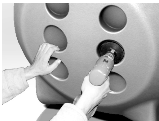
Рис. 11 СВЕРЛЕНИЕ ОТВЕРСТИЯ ДЛЯ УСТАНОВКИ ЗПТ
