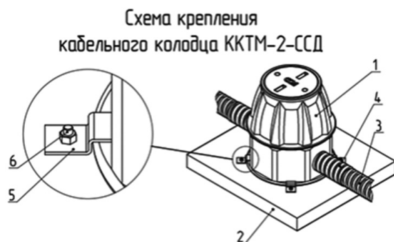
Рисунок Г.6 – Схема крепления кабельного колодца ККТМ-2-ССД
