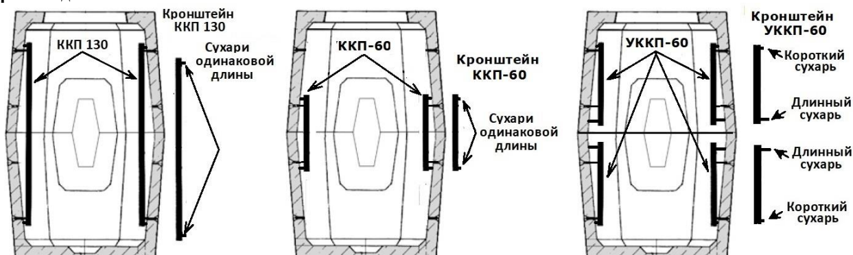
Рис. 2.2. Установка длинных, коротких и угловых коротких кронштейнов в колодцах ККСр с наклонными стенами.
