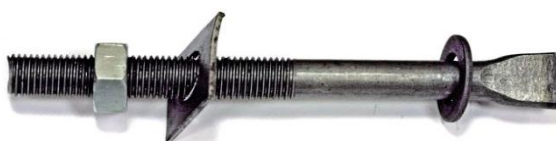
Рис. 2.10. Стальной ёрш с резьбой М12 и расплюснутым концом. В комплекте гайка, квадратная шайба и круглая шайба.
