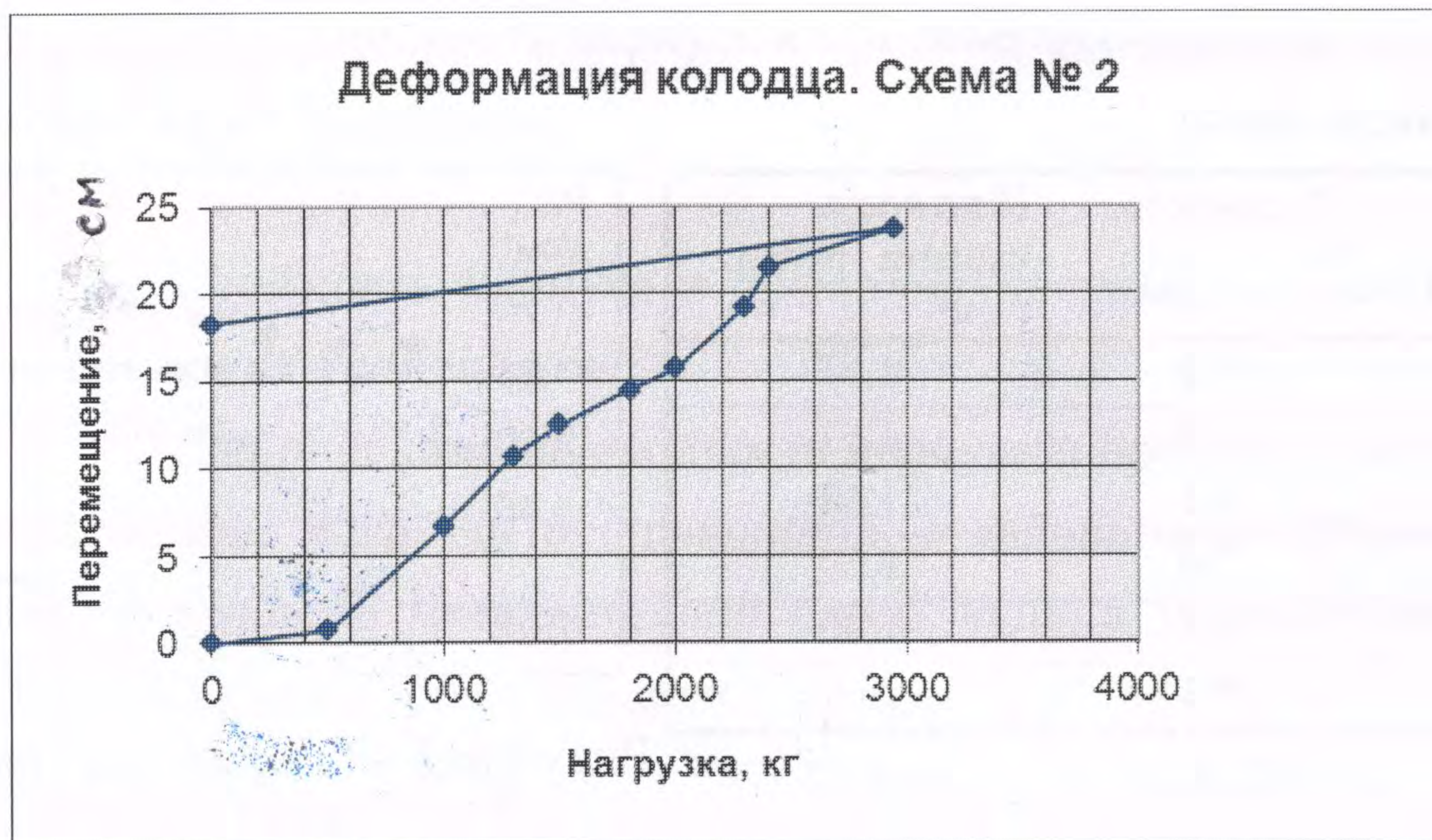
Рисунок 2 – График перемещения крышки люка при сосредоточенной нагрузке
